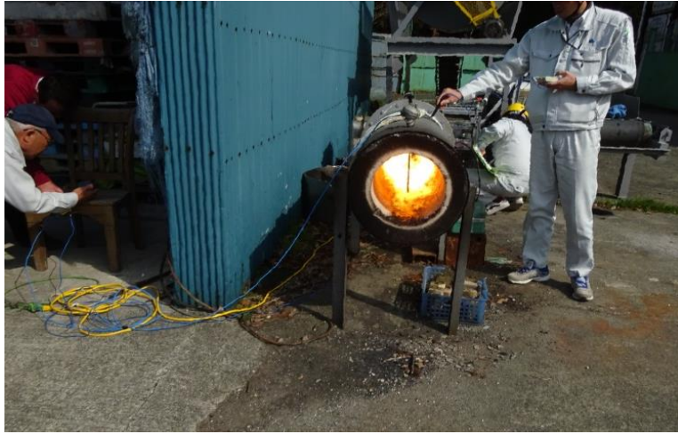
燃焼試験ボイラー(A重油のみ)
